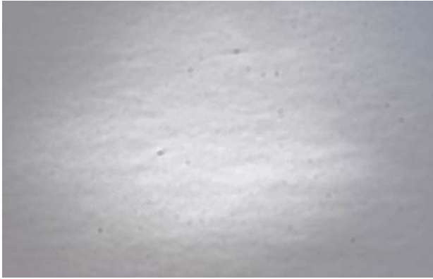
Abbildung 20: Sensorflecken sichtbar gemacht: So sah der Sensor meiner Vorserien-X-ProI nach drei Wochen Asieneinsatz aus. Diese Aufnahme eines Blatt Papiers entlarvt – mit entsprechend harten Kontrasteinstellungen am PC – über ein Dutzend Sensorflecken. Dagegen hilft kein Rütteln und kein Schütteln.
