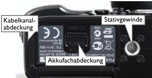
Abbildung 5: Untersicht der X-Pro I. Stativgewinde, Akku-/Speicherkartenfachdeckel und Kabelkanalabdeckung
