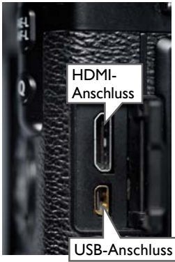
Abbildung 7: Seitenansicht der X-Pro I. geöffnertes Anschlussfach mit HDMI- Anschluss und USB-Port
