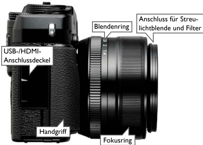
Abbildung 6: Rechte Seitenansicht der X-Pro (mit Objektiv XF35mmF1.4 R). USB-/HDMI-Anschlussdeckel, Handgriff, Blendenring, Fokusring, Anschluss für Streulichtblende und Filter
