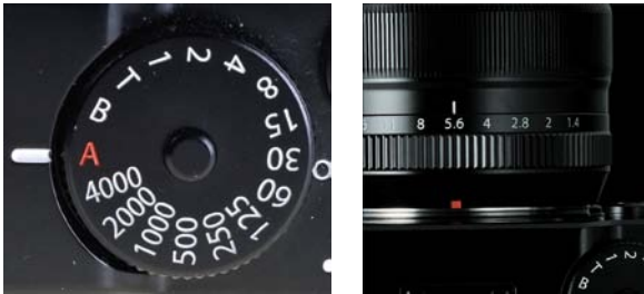
Abbildung 55: Auswahl der Belichtungssteuerung am Beispiel Zeitautomatik : Stellen Sie am Blendenring die gewünschte Arbeitsblende ein und wählen Sie am Belichtungszeitwähler die Position A für Automatik. Analog hierzu können Sie auch die drei anderen Modi der Belichtungssteuerung auswählen.
