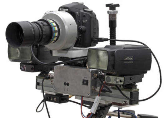
Der für die Fledermausfotos im Tierpark verwendete »Master«-Aufbau. Oben die Nikon D80 mit dem Rodagon 5,6/135, dazwischen der Zentralverschluss. Unten die Ansteuerelektronik, an die auch die Lichtschranke angeschlossen wird. Scharfgestellt wird mit einer Zörk Mini-Makro-Schnecke.
