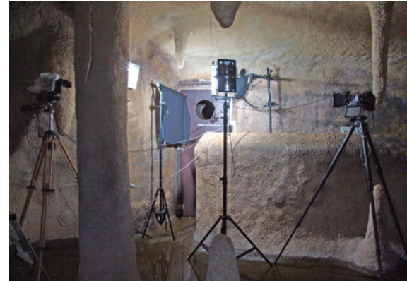
Aufbau in der »Villa Dracula« im Tierpark Hellabrunn München. Links eine Nikon D80 mit Rodagon 5,6/135 und PQS-Verschluss, rechts eine Nikon D300 mit dem Zeiss Makro-Planar 4/120 HFT PQS. Die D80 fungierte dabei als »Master«, die D300 als »Slave«. Vor dem Flugloch die senkrecht stehende Lichtschranke.
