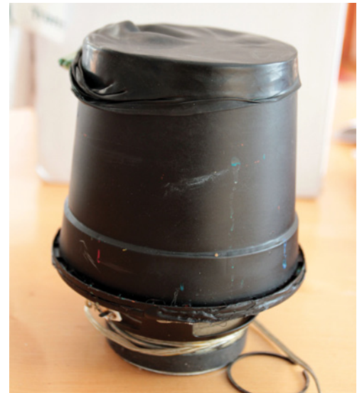
Der für das Umschlagbild eingesetzte Lautsprecher mit Gummimembran Foto: Michael Schmutz
