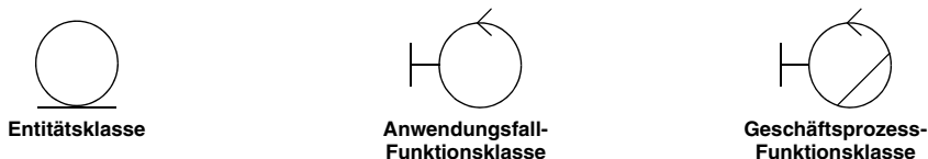
Abb. 24–1 Symbole der drei Klassen-Stereotype der Softwarespezifikation
