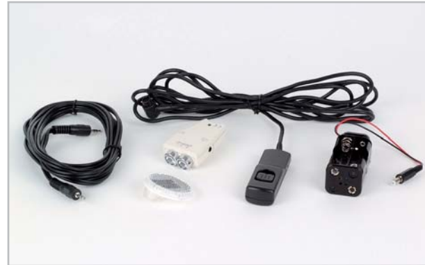
Die Einzelteile der Lichtschranke: v. l. n. r. Verbindungskabel Lichtschranke zu Auslöser, Reflektor, Lichtschranke, Auslöser mit passendem Kameraanschluss, Stromversorgung
