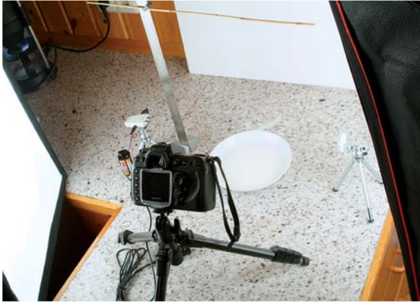
Abwurfhöhe und -position sollte man genau markieren, hier mit einem Lineal und einer dünnen Holzstange.
