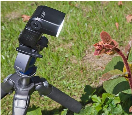
[7-28] Ein Erdnagel oder wie hier ein zweites Stativ hilft beim Platzieren des entfesselten Blitzes (ETTL-Steuerung über Licht).
