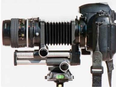
[7-8] Balgengerät mit Makroschlitten und einem Micro Nikkor 55mm/2,5 MF. Fokussierung und Blendensteuerung erfolgen manuell.
