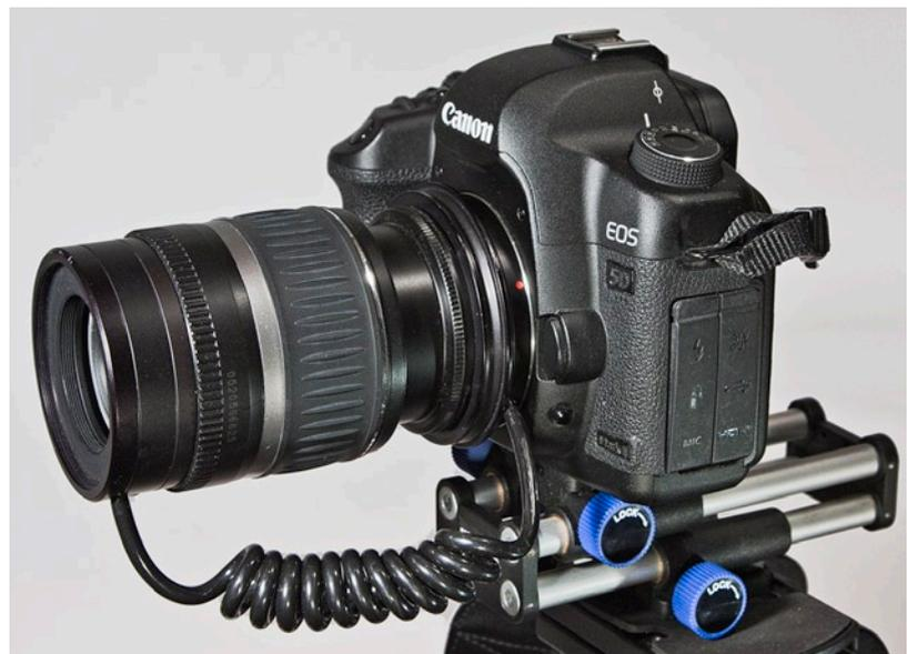
[7-18] Canon Kit-Zoom (18–55 mm) per Novoflex-Retroadapter an einer Canon 5D. Zum Fokussieren sitzt die Kamera auf einer Makroschiene.
