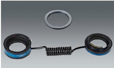
[7-17] Bei diesem Retroadapter-Kupplungsset von Novoflex [44] werden die Steuerdaten der Kamera vom Ring zwischen Kamera und umgekehrtem Objektiv elektronisch an den zweiten Adapter übertragen, der vorne am Objektivbajonett sitzt. Dies erlaubt z. B. die Blendensteuerung durch die Kamera.
