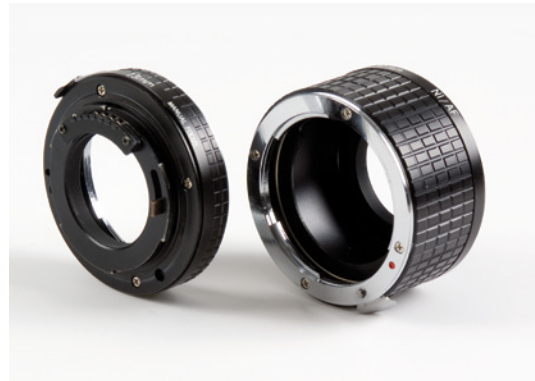
Zwischenringe verlängern den Auszug des Objektivs. Es gibt sie in festen Größen von 13 mm, 21 mm und 31 mm.
