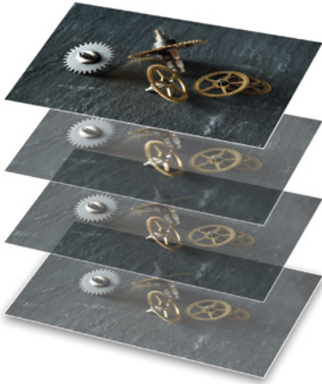
Beim Focus-Stacking werden mehrere Ebenen mit unterschiedlichen Schärfeeinstellungen miteinander kombiniert.
