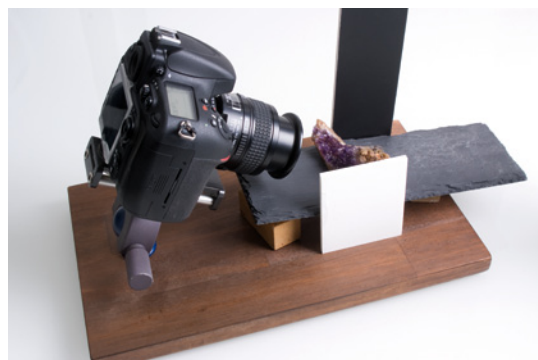
Um zu vermeiden, dass sich Kamera und Motiv verschieben, kann man den gesamten Aufbau auf ein stabiles Holzbrett montieren. Die Kamera sitzt auf einem Kugelkopf mit Einstellschlitten. Kleine schwarze und weiße Kartonstücke schatten die Beleuchtung gezielt ab oder dienen als Reflektoren.
