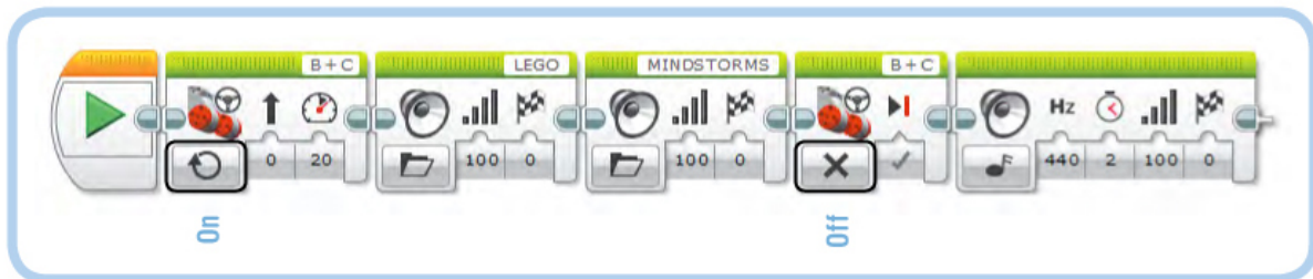
Abbildung 4-18: Das Programm OnOff. Achte genau auf die Einstellungen in den Bewegungslenkungsblöcken.
