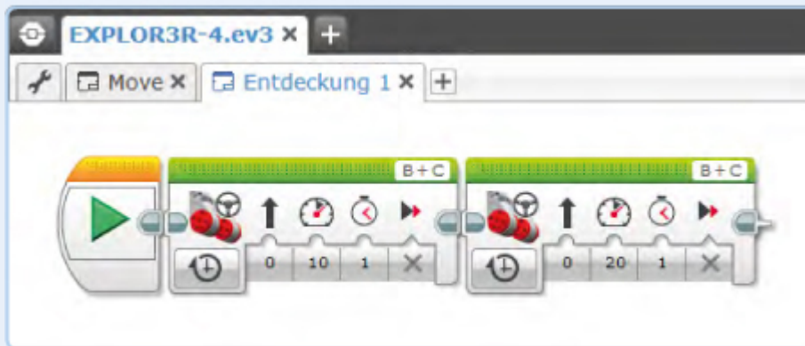
Abbildung 4-8: Die ersten Blöcke des Programms Entdeckung 1. Füge für jede Selbstentdecken-Aufgabe ein neues Programm hinzu und speichere es, wenn du fertig bist, sodass du sie später weiter verwenden kannst.
