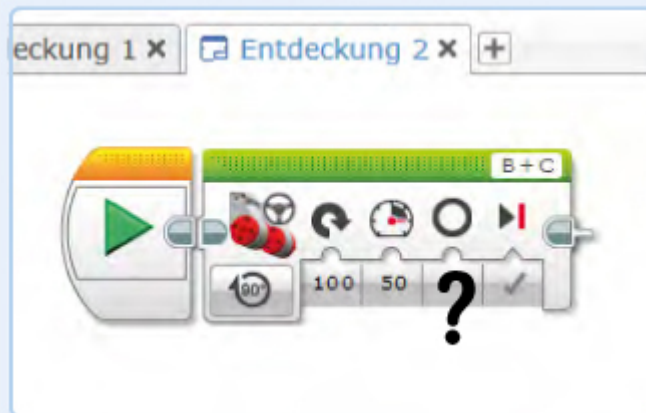
Abbildung 4-9: Das Programm für Selbst entdecken 2. Welcher Wert lässt den Roboter um 90 Grad wenden? Welcher Wert ist für 180 Grad notwendig?
