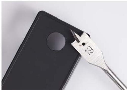
**Abb. 3-22** Das Loch für den Infrarotsensor
