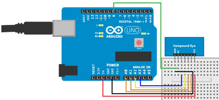
**Abb. 3–16** Anschluss des Facettenauges an den Arduino
