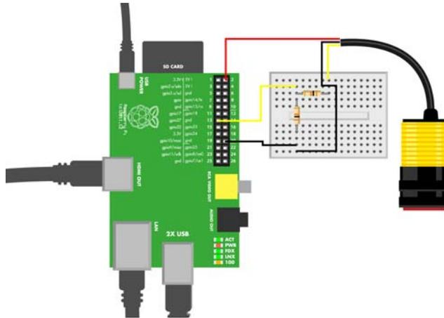
Abb. 3–11 Anschluss des Infrarotsensors an den Raspberry Pi
