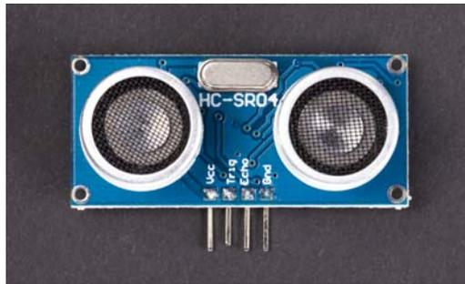
Abb. 3-4 Der Ultraschallsensor HC-SR04
