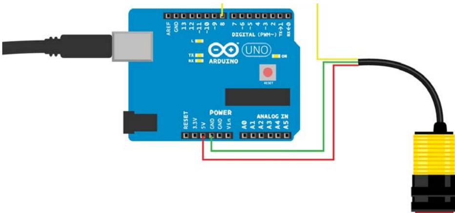
**Abb. 3-10** Anschluss des Infrarotsensors an den Arduino
