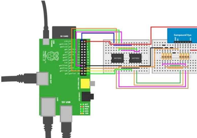
**Abb. 3-17** Anschluss des Facettenauges an den Raspberry Pi
