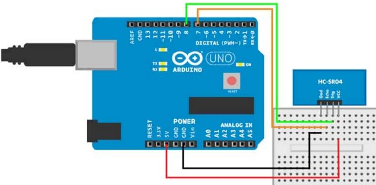
Abb. 3-5 HC-SR04-Schaltung für den Arduino
