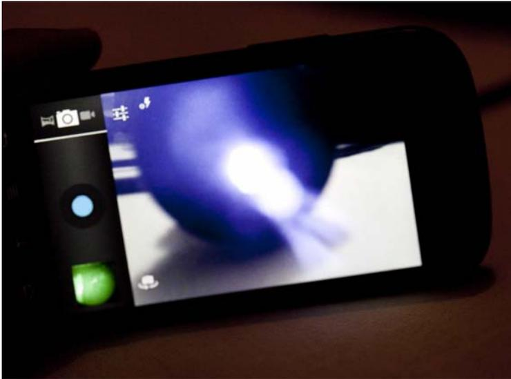
**Abb. 3-12** Ein IR-Sensor aus der Sicht einer Handykamera
