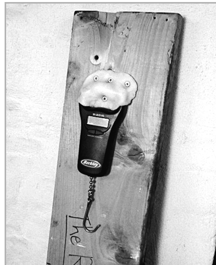
ABBILDUNG 4-13 MakerBot Industries hat The Rack verwendet, um die Zugkraft ihres Plastruder-Motors zu messen.
