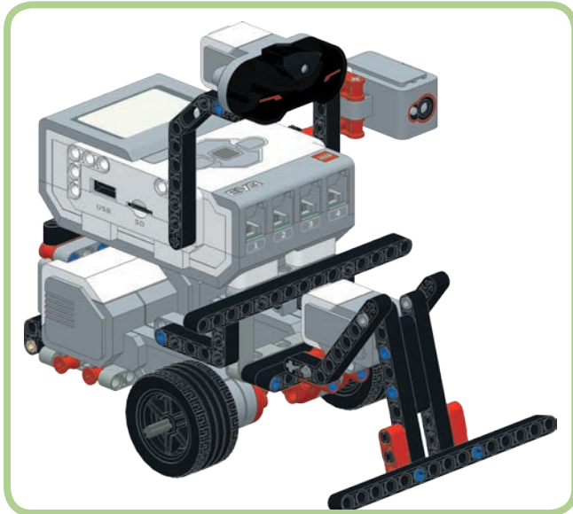
Abbildung 6-21: Aufbau des TriBots für das Programm BumperBot3
