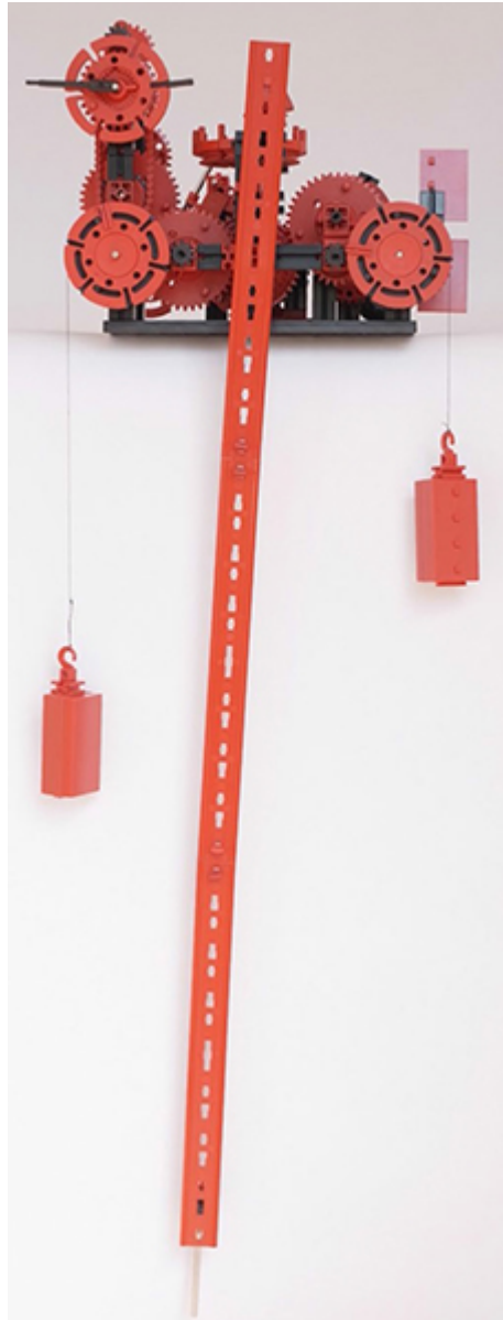
Abb. 4-1 Modell einer Turmuhr mit Spindelhemmung, Pendel und Schlagwerk
