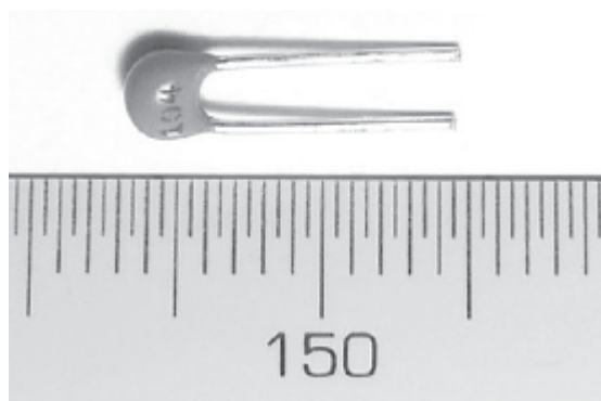
Abb. 4–4 Ein Keramikkondensator mit einer Kapazität von 0,1 \mu\text{F}
