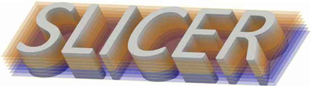
Abb. 1–7 Zerlegung eines 3D-Objekts (Schriftzug) in Scheiben
