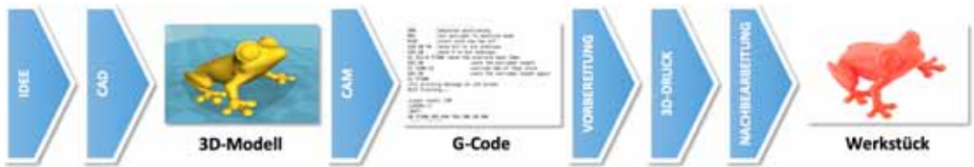
Abb. 1-11 Druckprozess von der Idee zum fertigen Werkstück
