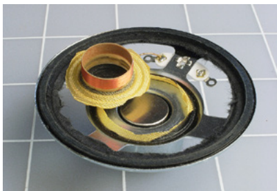
Abbildung 5-28. Die Schwingspule ist normalerweise innerhalb der Vertiefung des Magneten verborgen.
