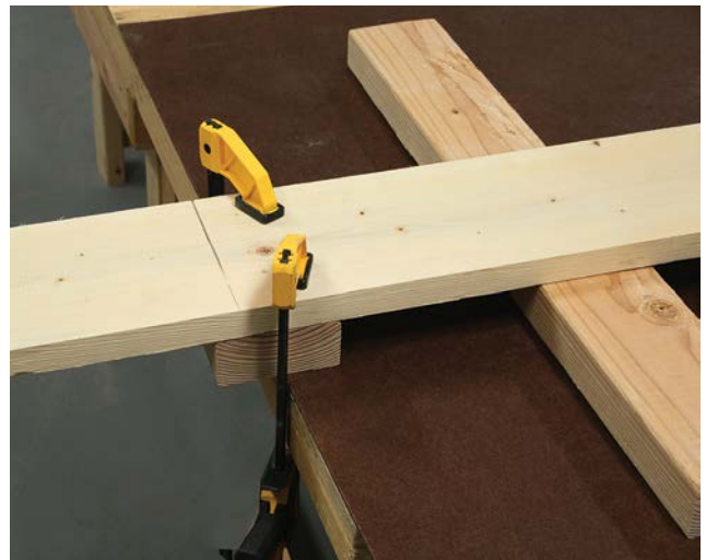
Abb. 4–9 Ein Brett 2,5 × 15, das nicht in eine Gehrlade passt, zuschneiden
