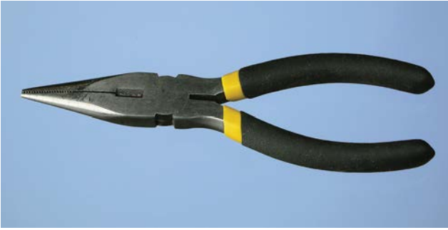
Abb. 4-2 Eine Spitzzange, etwa 15 cm lang, ist hilfreich, um Nägel zu halten, während man sie einschlägt.
