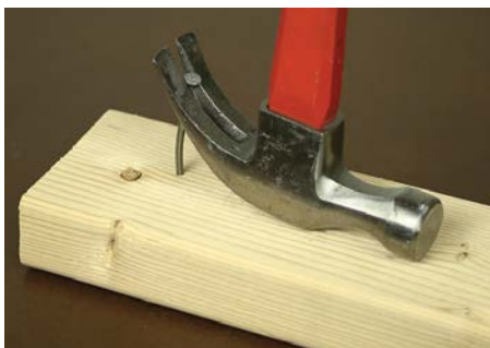
Abb. 4–6 Einen Nagel mit einem Tischlerhammer herausziehen
