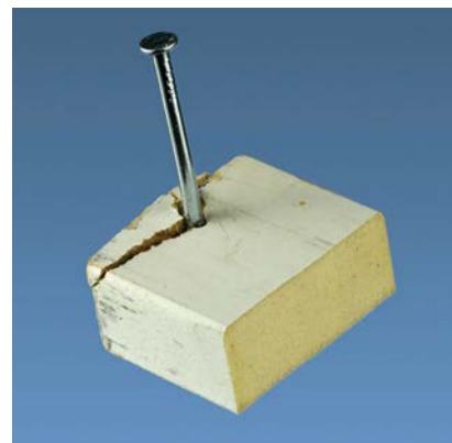
Abb. 4–8 Spanplatten lassen sich sehr leicht spalten.
