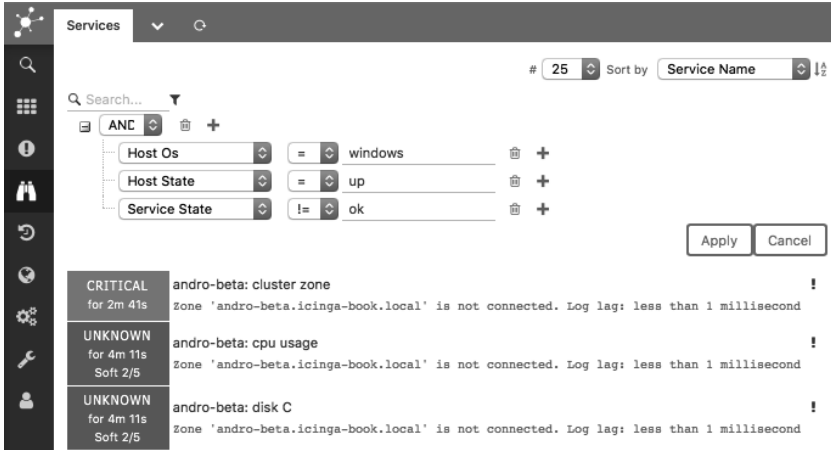
Abbildung 11-4: Servicefilter für Windows-Plattformen und Status
