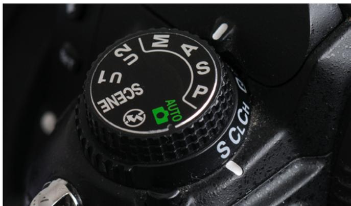
Links: Programmwahlrad bei einer Canon-Kamera. Av und Tv heißen bei den meisten anderen Herstellern A und S. Rechts: Programmwahlrad an einer Nikon-Kamera
