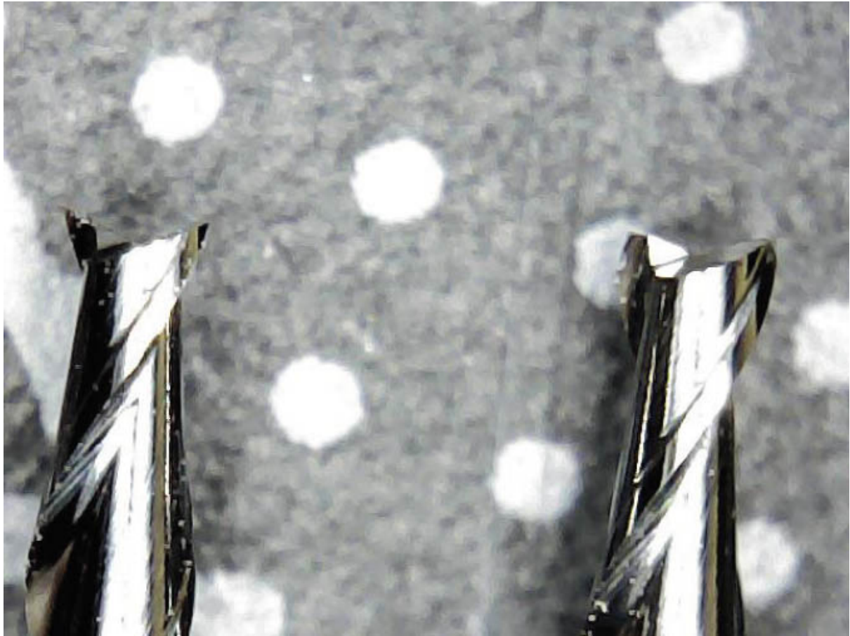
Abb. 4-38 Neuer Fräser vor der Alu-Dibond-Bearbeitung (links) und nach dem Fräsen (rechts)
