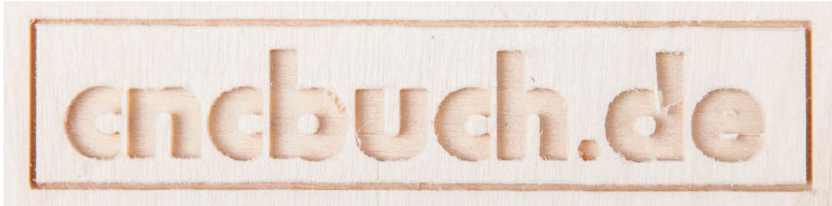
Abb. 4-10 Test mit anderem Fräser und anderen Schnittwerten
