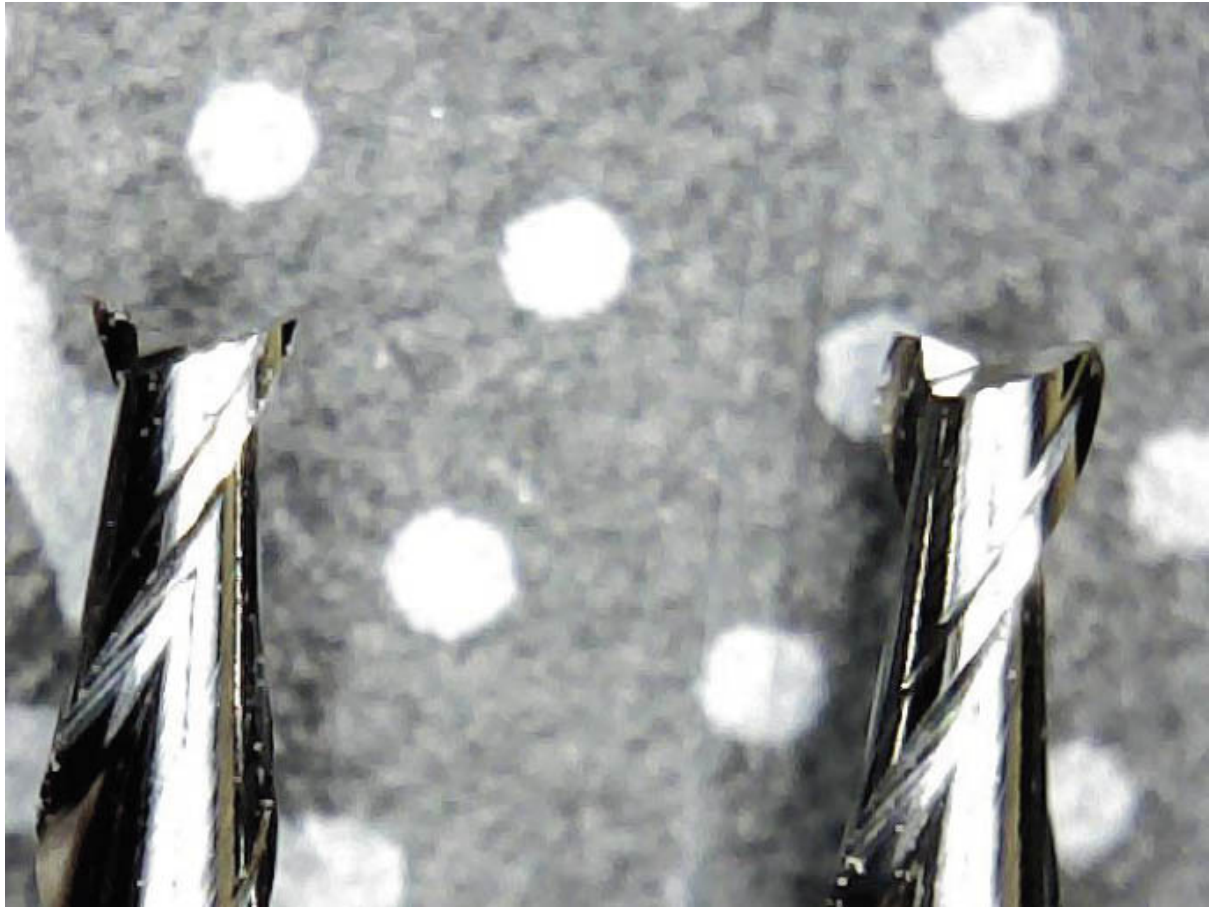
Abb. 4-35 Fräser neu (links) und nach der Bearbeitung des Messingschildes
