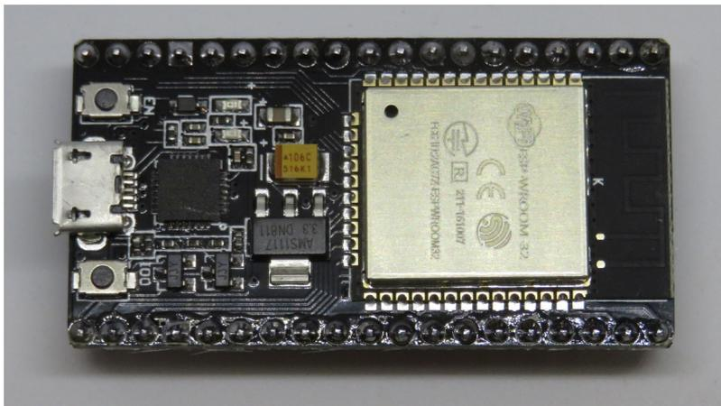
**Abb. 1-1** Der ESP32 ist auf diesem Modul verbaut.
