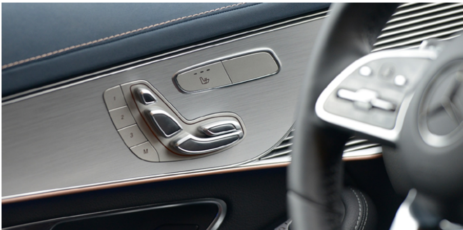
Abbildung 1-4: Bedienelemente zur Sitzverstellung im EQC-400-Prototyp von Mercedes-Benz aus dem Jahr 2020, inspiriert durch das mentale Modell eines Autositzes (Quelle: MotorTrend, 2018)
