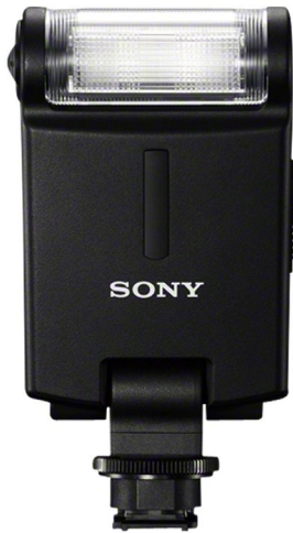
Abbildung 7.1: Der kompakte Programmblitz »HVL-F20M« ist in aufgeklappter Stellung aktiviert. Der Reflektor ist wesentlich weiter von der optischen Achse entfernt als der interne Blitz, was die Gefahr roter Augen bei Porträts verringert (Foto: Sony).
