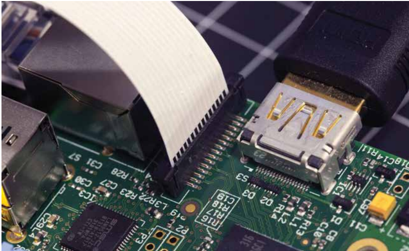
Abb. 9–5 Nachdem das Flachbandkabel in den Anschluss der seriellen Schnittstelle der Kamera eingesteckt und fixiert wurde, sehen Sie möglicherweise immer noch die Metallkontakte auf dem Flachbandkabel.
