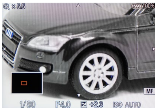
Abb. 3.29 Ist MF-Unterstützung eingeschaltet, vergrößert die a7 IV das Bild. Das soll Sie beim Finden des exakten Schärfepunkts unterstützen.
