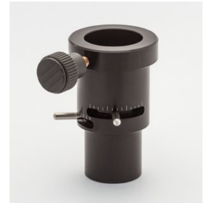
Ein Dispersionskorrektor besteht aus zwei drehbaren Prismen, die so konstruiert sind, dass sie atmosphärische Dispersionen durch ihre eigene, aber entgegengesetzte Dispersion ausgleichen. Der Korrektor wird vor dem Sensor platziert. Die Einstellung der Prismen nimmt man manuell vor, während man einen Stern (durch ein Okular oder das Kamerabild) betrachtet, der die gleiche Elevation über dem Horizont hat wie der Planet. Nach jeder signifikanten Veränderung der Elevation muss diese Einstellung angepasst werden.
