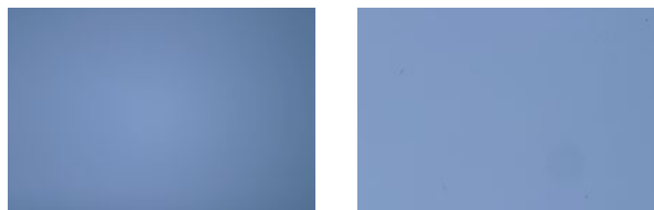
Bilder des blauen Himmels, die mit einer Digitalkamera aufgenommen wurden, bei dem die Blende des Objektivs auf 2,8 völlig geöffnet wurde (links) bzw. mit Blende 32 die kleinste Öffnung gewählt wurde (rechts). Mit zunehmendem Blendenwert (kleinerer Blendenöffnung) tritt die Vignettierung weniger ausgeprägt auf, die durch Staubpartikel verursachten Schatten werden jedoch kleiner und schärfer. Der breitere Lichtstrahl bei geöffneter Blende erzeugt dabei größere Schatten mit weniger Kontrast, wohingegen der engere Lichtstrahl Schatten ergibt, die kleiner, aber stärker sichtbar sind.
