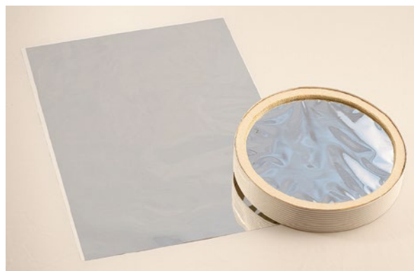
Eine AstroSolar-Folie, die man sich zuschneidet und in eine selbst gebaute Halterung einfasst.
