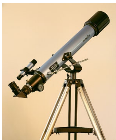
Mit einer azimutalen Montierung, die nicht motorgesteuert ist, kann man zwar die Mondscheibe fotografieren, doch für Planeten ist sie nicht ideal.
