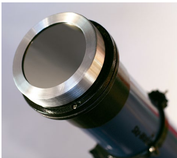
Ein Glas-Sonnenschutzfilter in seiner Halterung. Bei kleinen Teleskopen reicht der Filter über die gesamte Öffnung, für größere Systeme gibt es Filter mit kleinerem Durchmesser, die nur in einem kleineren runden dezentralen Bereich (Off-Axis-Filter) Licht hindurchlassen.
