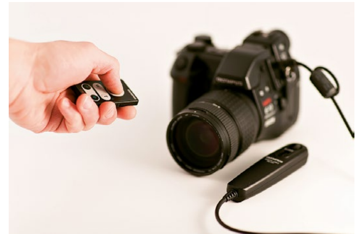
Mit einem Fernauslöser (die Kamera oben kann sowohl mit einem Draht- als auch mit einem Infrarotauslöser ausgelöst werden) lassen sich Erschütterungen der Kamera bei der Auslösung zuverlässig vermeiden.
