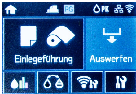
[3] Das 55 × 42 mm große Touch-Panel dient der Information und der Administration.
