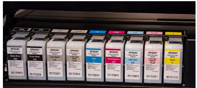
[2] Die neun Tinten mit einer Kapazität von jeweils 80 ml (bei neuen, vollen Patronen) – links die vier Schwarz-/Grautinten.
