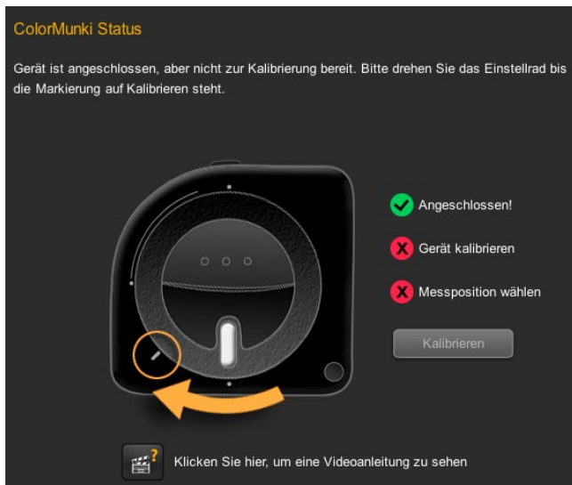
Abb. 3-17: Bringen Sie das Messgerät zunächst in die Kalibrierstellung, klicken Sie anschließend auf Kalibrieren ...
