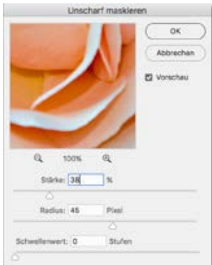
[4-83] Eine geringe Stärke, aber ein großer Radius beim Filter Unschärf maskieren erhöht den Mikrokontrast.
